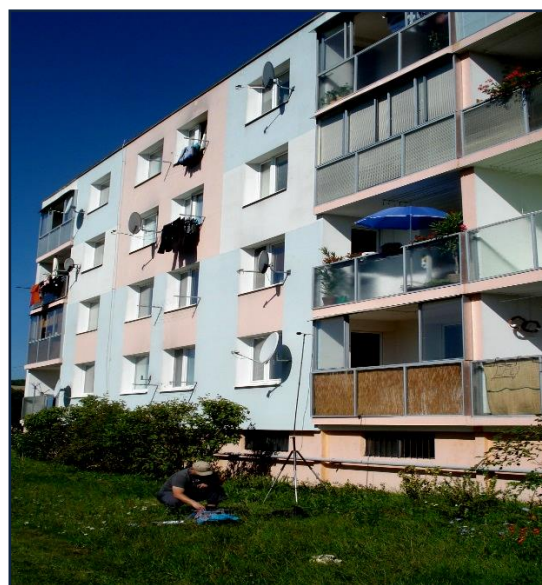
Obr. 68 Meranie hlučnosti - umiestenie mikrofónu, zdroj RÚVZ BB
