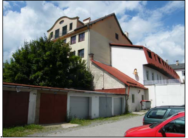
109. Dolná 21, meštiansky dom. Celoplošná dostavba parcely, v závere s hmotovo neprimeraným 4-podlažným objektom, presvetlenie podkrovia masívnym vikierom
